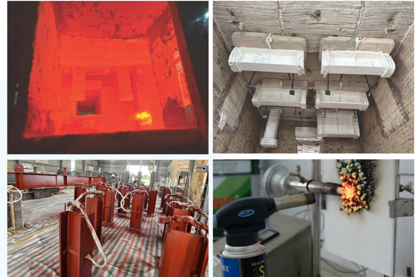
Lò thử nghiệm sơn chống cháy Fireproof paint testing furnace
